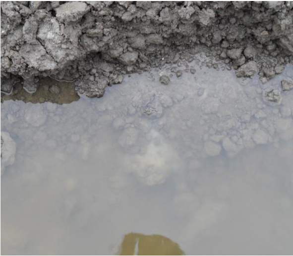
Figuur 4.4 Zandspoortje bij afwezigheid van deklaag
