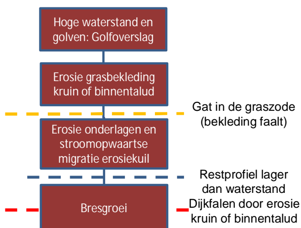
Figuur 7.11 Gebeurtenissen leidend tot falen van de dijk door erosie van de grasbekleding op kruin of binnentalud
