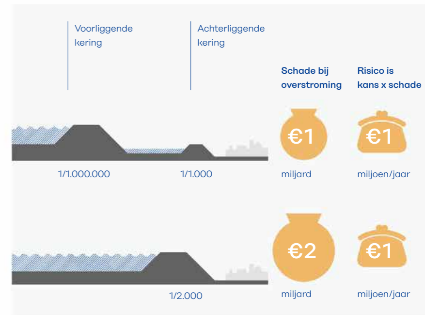
Figuur 4.13 Twee oplossingen, met en zonder voorliggende kering, die hetzelfde risico opleveren. Zonder voorliggende kering is de schade groter omdat er meer water binnenkomt.
