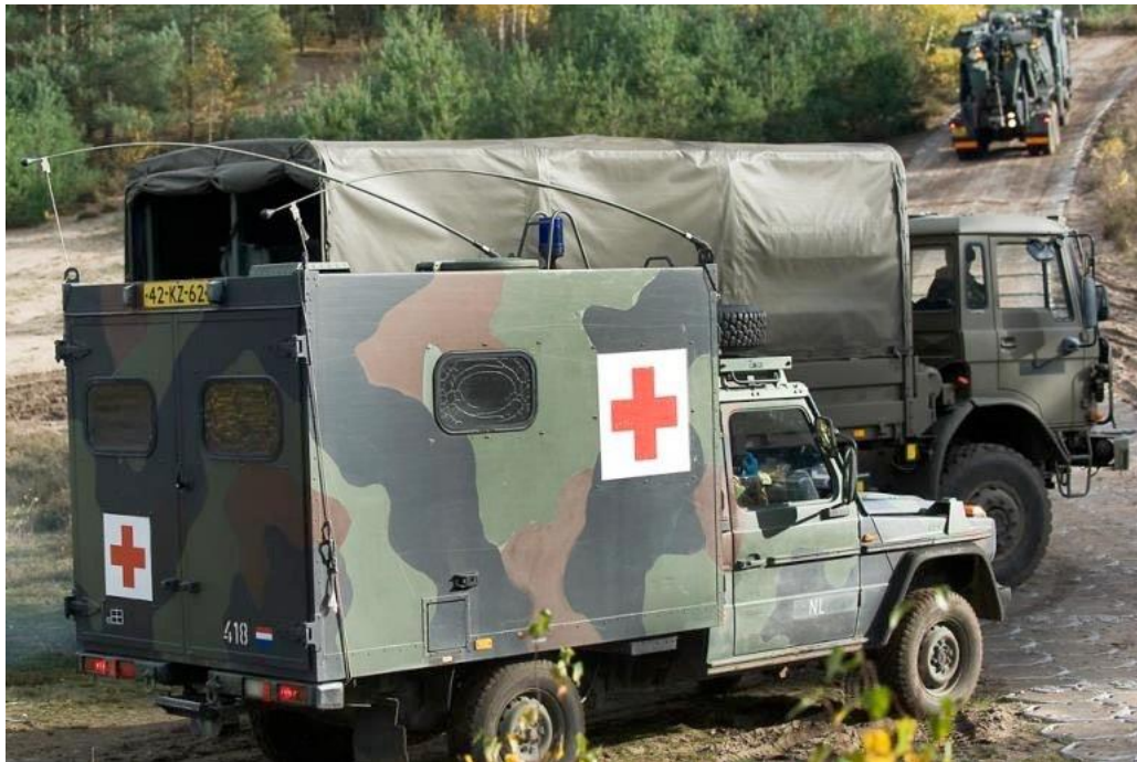
Mogelijke onderdelen van de DNOM in beeld: op de voorgrond een ziekenauto en een YAP4240, op de achtergrond rijdt het YBZ-3300 bergingsvoertuig en op de grond ligt een MLC-70 wegmatt (rechts op foto).
